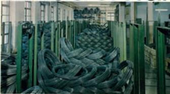
Der geordnete Fertigungsablauf unseres Betriebes, das umfangreiche Drahtlager als Ausgangspunkt unserer Fertigung, der weiträumige Maschinenpark und die laufenden Material- und Fertigungskontrollen gewährleisten die bekannte Qualität für Betzer-Schrauben.
